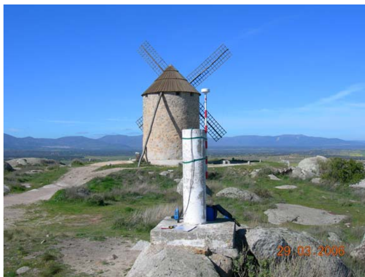
Foto 2.1. Equipo instalado en un vértice actuando como base GPS.
