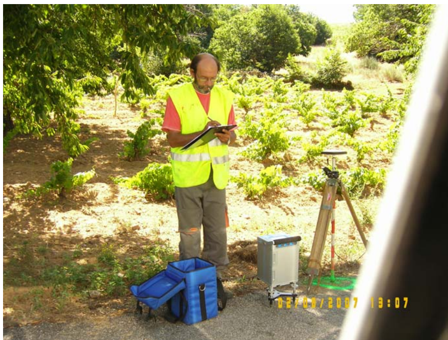
Foto 2.2 Medida simultánea de gravimetría y GPS en un punto de la campaña.
